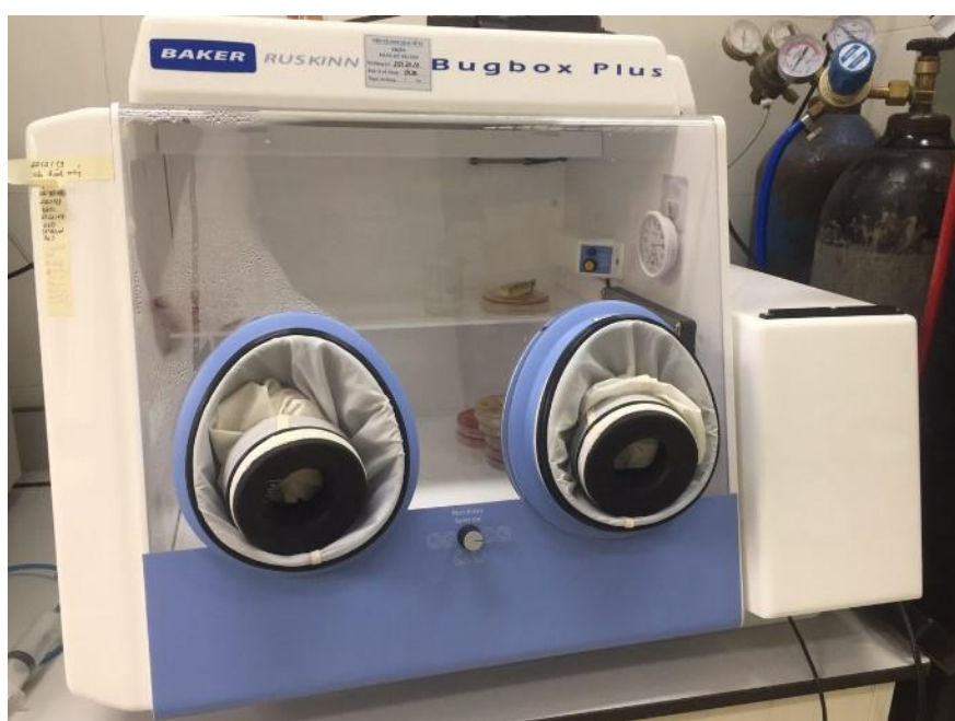
Hình 2.2: Tủ kỵ khí BugBox Plus, hãng Baker Ruskinn – Anh
