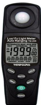
Hình 6. Máy đo cường độ ánh sáng Tenmars TM 205
